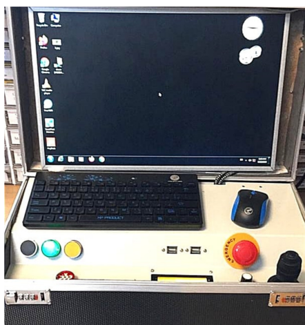
شکل ۱۲- نمونه صنعتی صفحه نمایشگر، جوی استیک و انواع کلیدهای کنترلی
