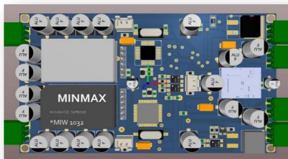
شکل ۱۰- نمونه برد الکترونیکی طراحی شده برای ربات بازرسی لوله
